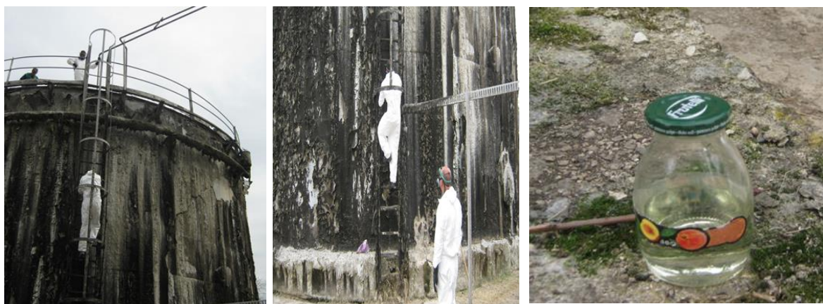
Слика 15 Земање на примерок за анализа од акрилонитрил мономер од резервоарот и изглед на примерокот
