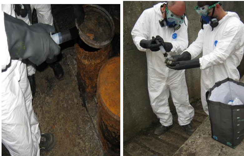
Слика 16 Земање на примерок за анализа од бурињата со AZDN
